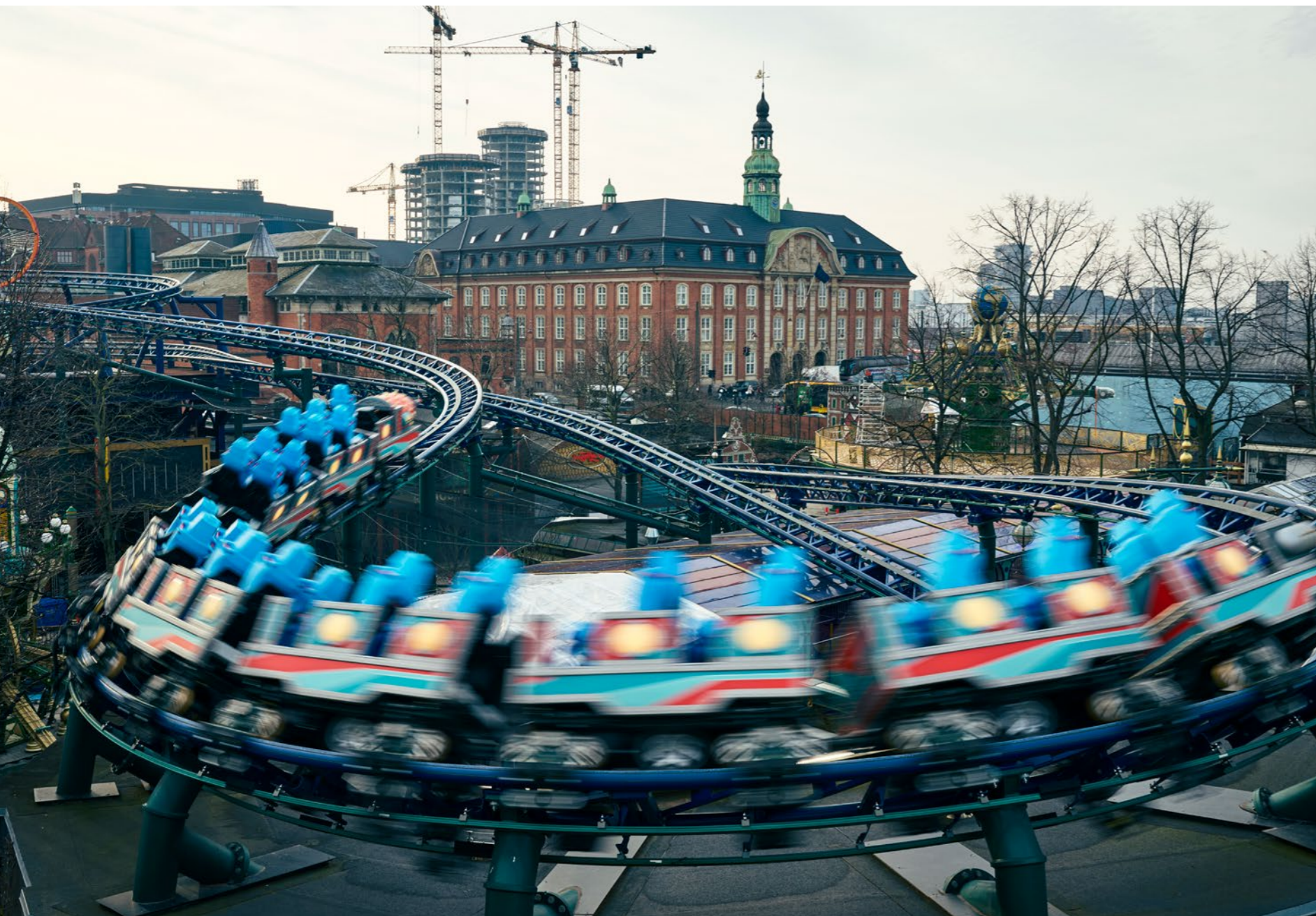
Rutsjebanen Mælkevejen kører testkørsel – i stedet for passagerer køres der med store dunke fyldt med vand.
