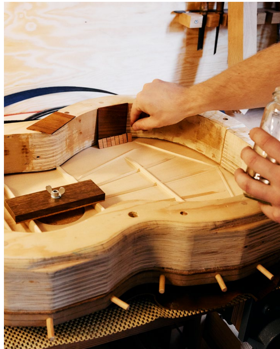
2/ Henrik lægger små kiler hele vejen rundt i kanten af siden. På den måde skabes en overlade som kan limes.
