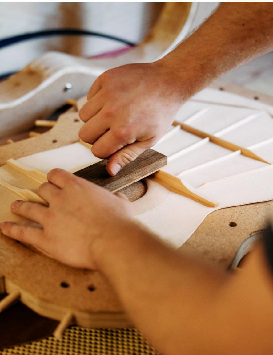
1/ Henrik samler guitaren i en solera. Først bliver bagsiden spændt fast, så Henrik er sikker på at den ikke rykker sig.
